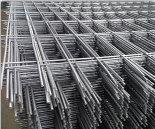
Panneaux de treillis stocké
